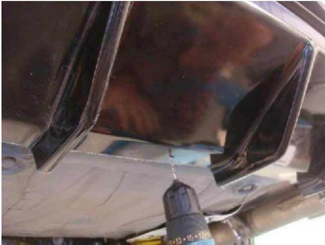
Abb. 20 +21 Zur Befestigung im mittleren Bereich des Heckeinsatzes wird eine Montagebohrung \varnothing 2,5\text{mm} im ABS-Winkel, der bereits am Fahrzeug Heck verklebt ist, angebracht. Die Bohrung im Heckeinsatz dafür liegt bereits vor. Anschließend wird der Heckeinsatz mittels Torxschraube 5,0x16mm (VW) mit angepresster Scheibe \varnothing 15\text{mm} am ABS-Winkel verschraubt.
