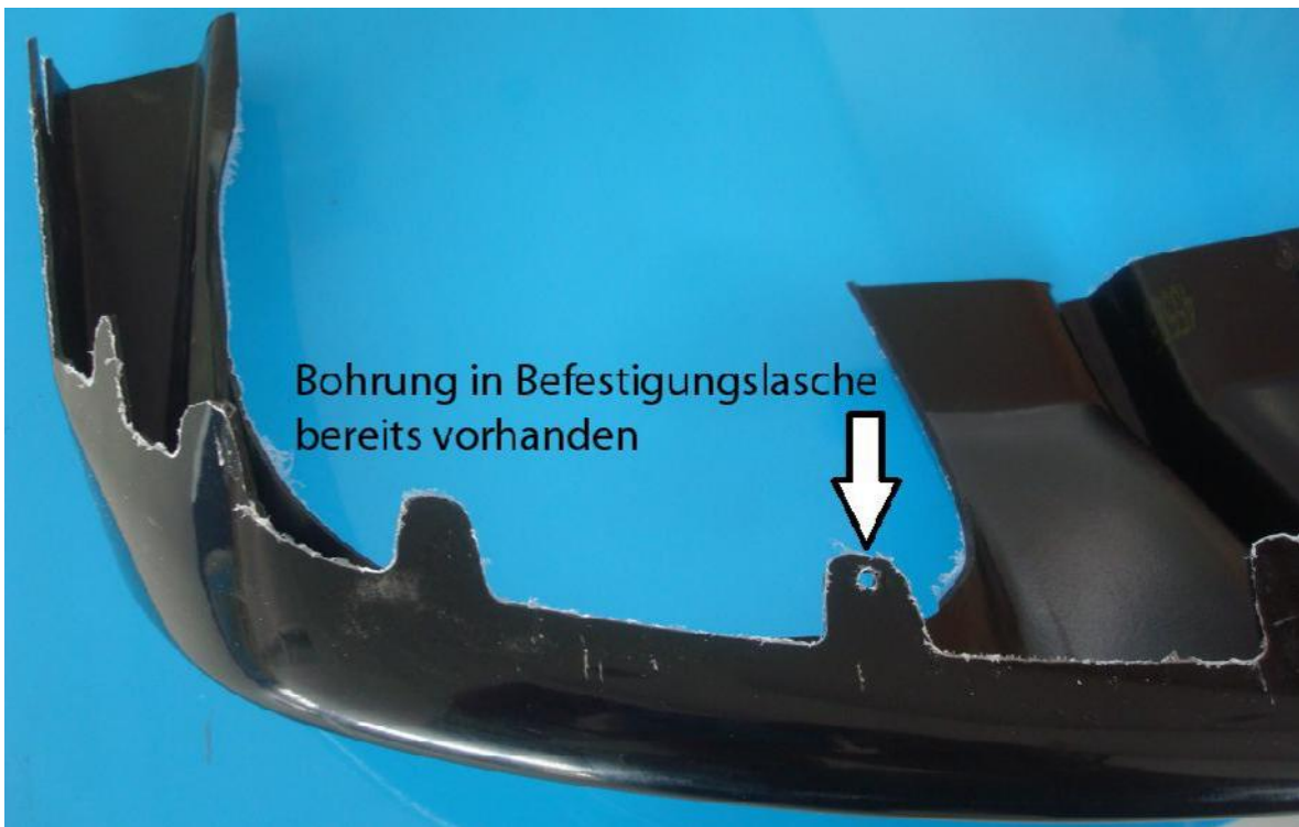
Abb. 17 im Bereich über der Endrohraussparung (links + rechts) ist im Heckeinsatz bei jeweils einer Befestigungs- lasche bereits eine Bohrung vorhanden.
