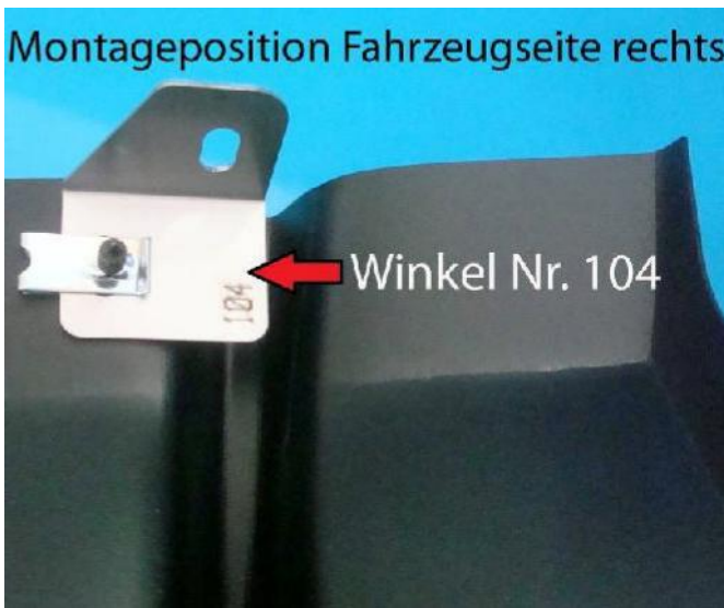
Abb. 22 +23 Zur Befestigung an den beiden äußeren Bereichen des Heckeinsatzes wird jeweils eine Torxschraube 5,0x16mm (VW) mit angepresster Scheibe \varnothing 15\text{mm} mit den bereits montierten Montagewinkeln (Nr. 103 + 104) verschraubt. Die Bohrungen im Heckeinsatz dafür liegen bereits vor. Hier ist der Montagewinkel-Nr. 104 dargestellt, der auf der Fahrzeugseite rechts montiert wird. Dieser Winkel ist asymmetrisch. Deshalb muss die Montageposition wie abgebildet durchgeführt werden.
