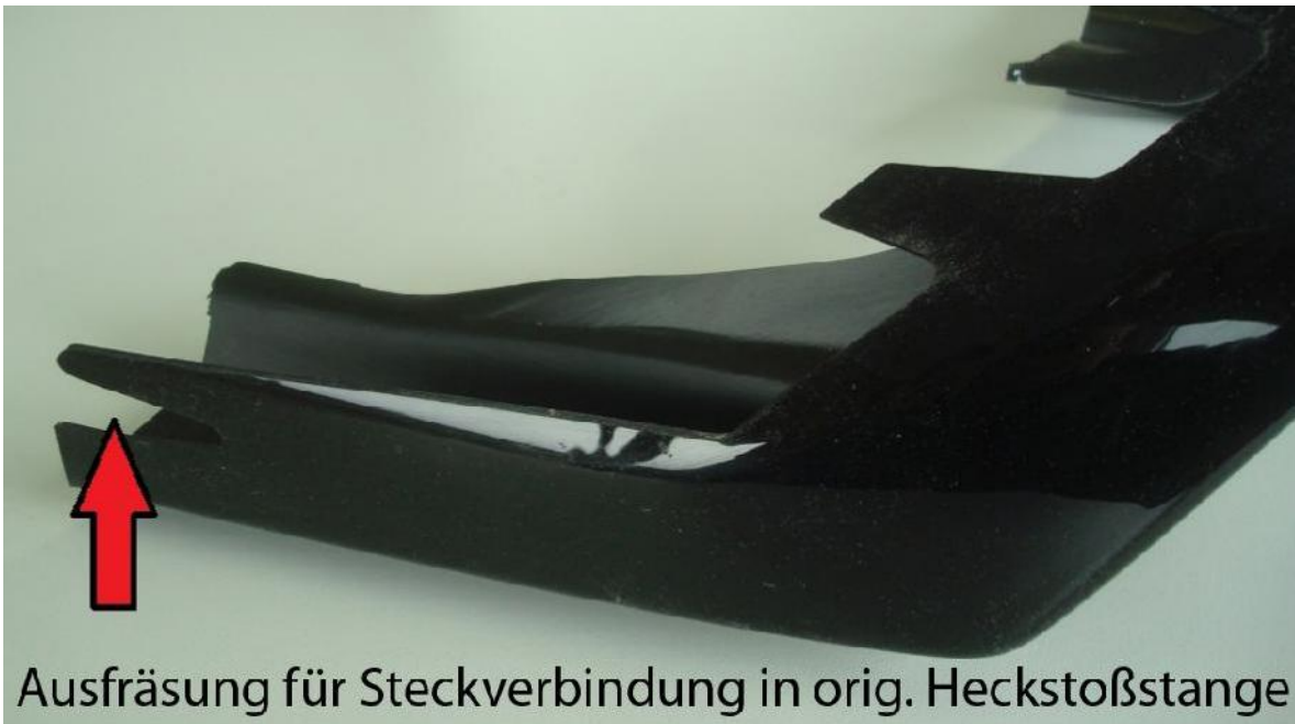
Abb. 16 Ausfräsung im Heckeinsatz dient der Steckverbindung in orig. Heckstoßstange.
