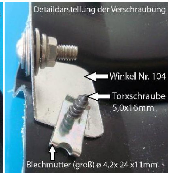
Abb. 22 +23 Zur Befestigung an den beiden äußeren Bereichen des Heckeinsatzes wird jeweils eine Torxschraube 5,0x16mm (VW) mit angepresster Scheibe \varnothing 15\text{mm} mit den bereits montierten Montagewinkeln (Nr. 103 + 104) verschraubt. Die Bohrungen im Heckeinsatz dafür liegen bereits vor. Hier ist der Montagewinkel-Nr. 104 dargestellt, der auf der Fahrzeugseite rechts montiert wird. Dieser Winkel ist asymmetrisch. Deshalb muss die Montageposition wie abgebildet durchgeführt werden.
